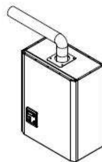
標準安裝排氣管總長度 25 公分+1 個 90 度彎管
